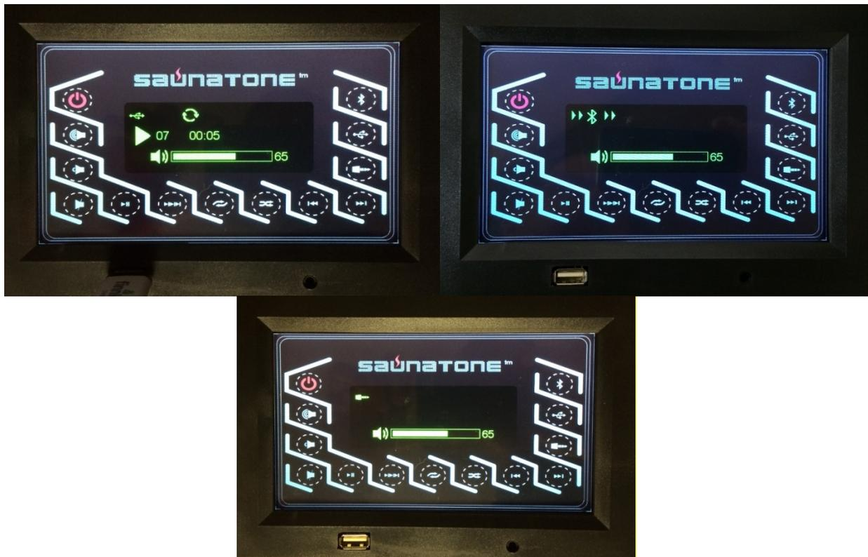
Quelques secondes plus tard, l'écran Audio revient automatiquement en mode Tableau de commande. Une icône au milieu de l'écran indique la fonction audio activée dans l'écran Audio.
