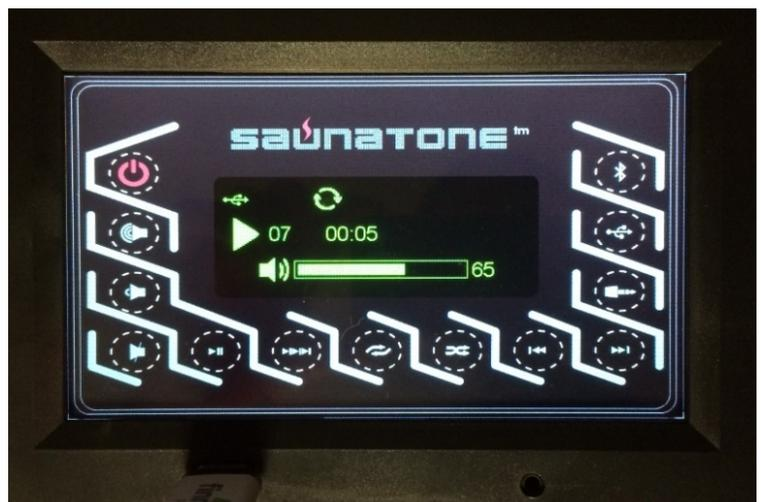
connexion. Au bout de quelques secondes, un message doit indiquer le périphérique comme étant connecté. Le périphérique source et l'écran tactile piloteront la commande de volume.
