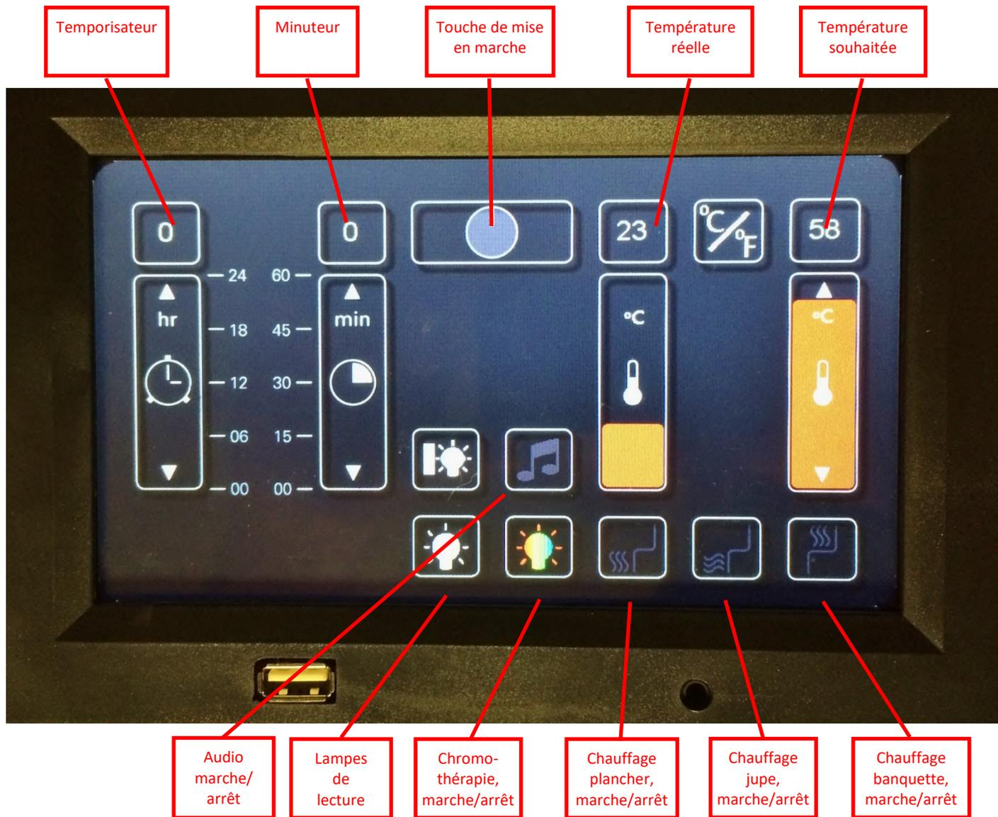
**Alimentation principale :** Appuyez sur **POWER** dans la partie centrale supérieure de l'écran. Si la lumière rouge s'allume, la cabine **SOUS TENSION**. Si la lumière est blanche, la cabine est **HORS TENSION**.
