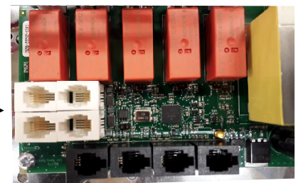
Figura 5 . Ordine dei connettori RJ 10. Sensore, interruttore porta, controllo remoto, NTC aggiuntivo
