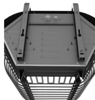
4. Установите нижние винты настенного крепления. Затяните верхние винты.
