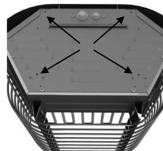
3. Bringen Sie die Wandhalter des Heizgeräts mit den beiliegenden vier Schrauben (4,2 x 32,0 mm) so an, wie in der Abbildung zu sehen ist. Montieren Sie das Heizgerät an der Wand.
