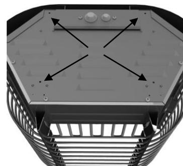
3. Fäst bastuaggregatet väggfästen med de medföljande skruvarna 4,2 x 32 mm (4 st.) enligt bilden. Montera bastuaggregatet på väggen.
